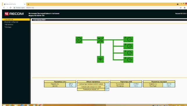
Отображение структурной схемы ИБП в **различной цветовой гамме** с выводом основных параметров позволяет вести наблюдение за состоянием оборудования на некотором удалении от экрана монитора.
