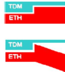
Разделение TDM-трафика позволяет распределить трафик существующей сети, например HSPA-данные, по IP-сети с помощью функции эмуляции псевдоканала (PWE), сохраняя только важные данные, чувствительные ко времени, в TDM-сети. Данная функция позволяет модернизировать существующую сеть, увеличивая при этом объемы пользования IP-сетью.
