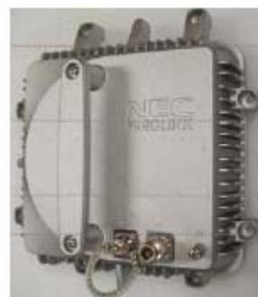
Рисунок 5.3 ODU, работающий в диапазоне 6 – 11 ГГц
